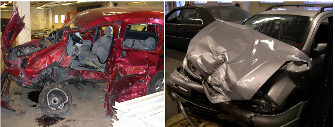
Figur 1 Deformationer av kollision mellan ungefär lika tunga bilar. Opel (fotot till höger) körde nästan vinkelrätt in i sidan på en styvare del av Renaulten (vänster). Hovrätten ansåg att Opelns fart inte var väsentligt högre än 50 km/h.
